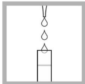
Agrega 6 gotas de solución indicadora de pH de amplio rango en el segundo tubo.
